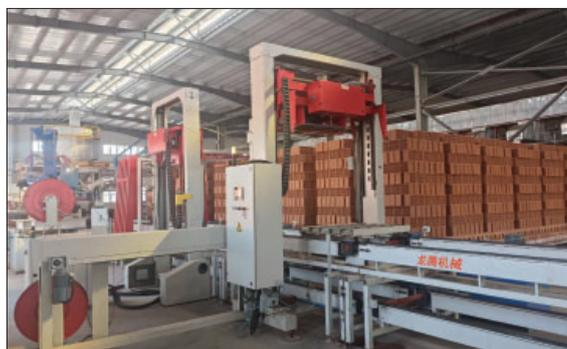
Автоматическая линия обвязочных машин D&S
