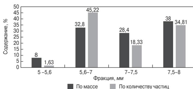
Рис. 1. Распределение твердых частиц щебня по крупности
