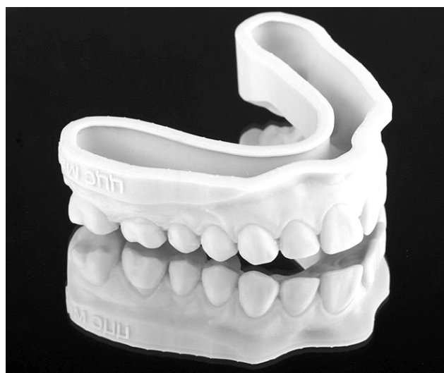
Рис. 2. Модель верхней челюсти, напечатанная на 3D-принтере Formlabs (США).
