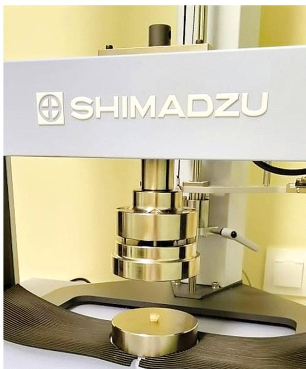
**Рис. 2.** Разрывная машина серии AG-Xplus (Shimadzu).
