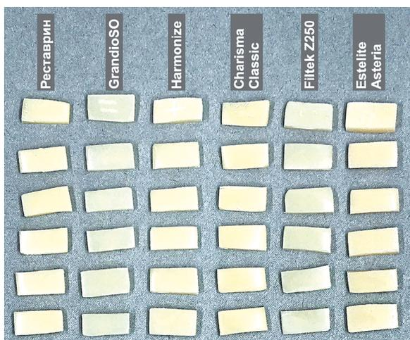
**Рис. 5.** Образцы композитных материалов после полирования.
