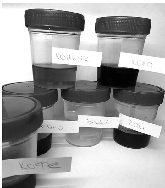
**Рис. 1.** Образцы композитных материалов помещены в герметичные ёмкости с красящими средами.
