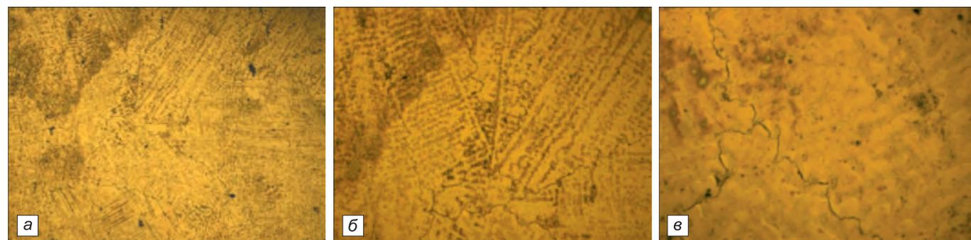
Рис. 5. Микроструктура сплава I-MG (стандартная).
