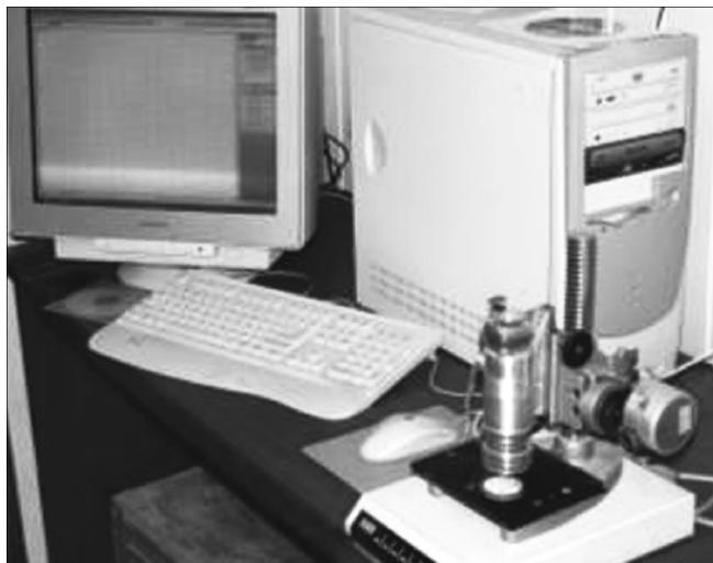
Рис. 1. Приборы для определения прочностных характеристик твердых тканей зуба.
