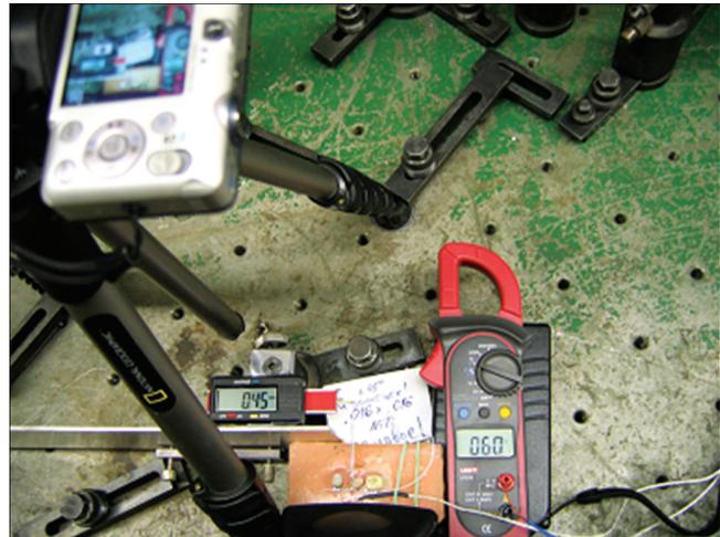
Рис. 2. Устройство для видеорегистрации процесса восстановления ротированного зуба и контроля температуры.
