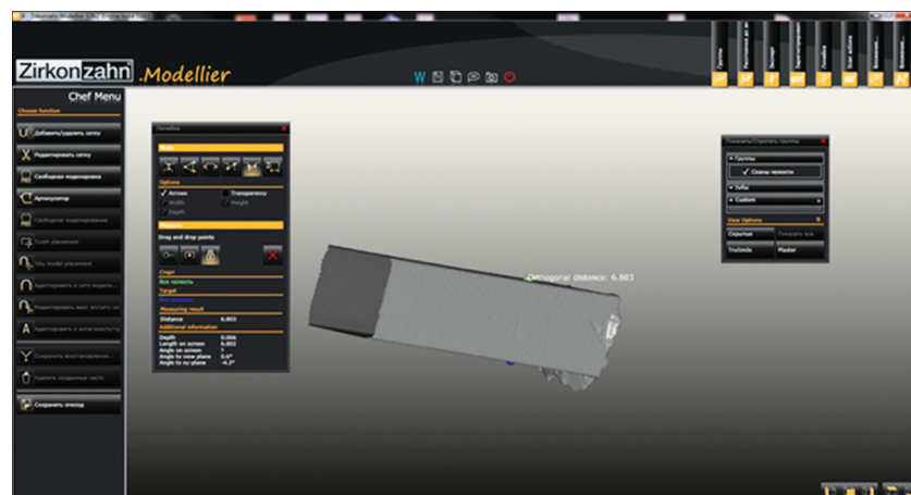
Рис. 6. Определение нормируемого размера цифровой модели гипсового штампа.
