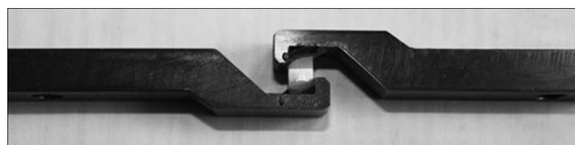
Рис. 4. Образец вклеен в приспособление для испытаний на сдвиг.
