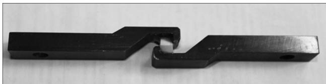
Рис. 1. Приспособление для испытания на смещение.
