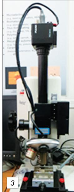
Рис. 3. Оптический микроскоп в составе адгезиметра Revetest.
