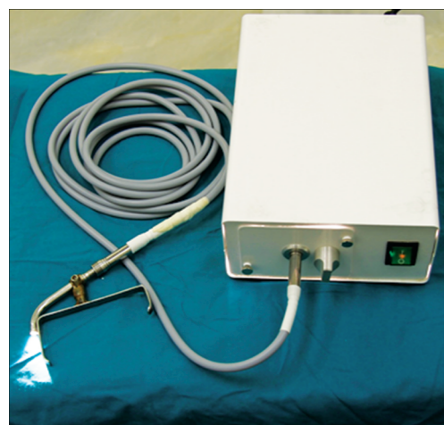
Рис. 1. Осветитель галогенный ОГ-150-02 с подсоединенным световолоконным кабелем и операционным крючком-ретрактором.
