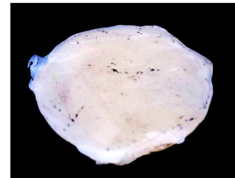
Рис. 7. Результат воздействия чистящей насадки 3D White на ингибированный слой на поверхности отвержденного образца композитного материала: ингибированный слой определяется только в области дефектов структуры и неровностей поверхности.
