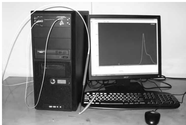
Рис. 2. Аппарат для проведения локальной флуоресцентной спектроскопии "Спектр-Кластер"
