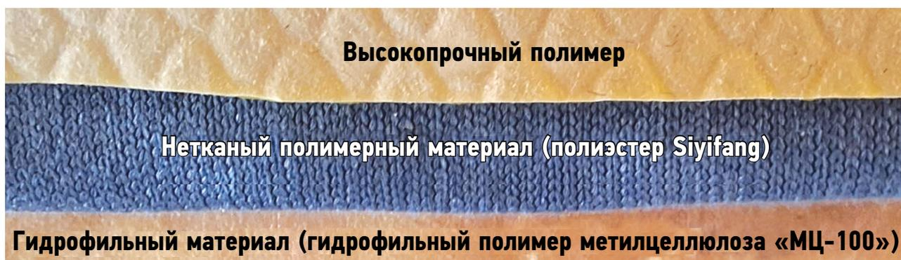
**Рис. 2.** Структура стоматологической накладки, предназначенной для защиты слизистой оболочки полости рта, сверху вниз: наружный слой из высокопрочного полимера; средний слой из нетканого полимерного материала, полиэстера Siyifang (Cordura Oxford Fabric, Китай); внутренний слой из гидрофильного материала «МЦ-100» (Defy, Россия), соединённых между собой клеем Technomelt PS 1540 (Henkel Adhesives, Германия).
