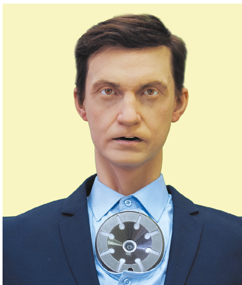
Рис. 1. Антропоморфный стоматологический робот-пациент. Fig. 1. Anthropomorphic dental robot patient.
