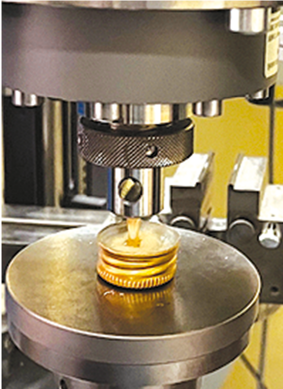
Рис. 1. Образец в испытательной машине Z010 (Zwick/Roell, Германия). © Эко-Вектор, 2024.
