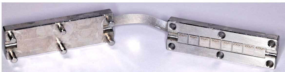
Рис. 1. Анализатор для измерения толщины силиконовой плёнки. © Эко-Вектор, 2025.
