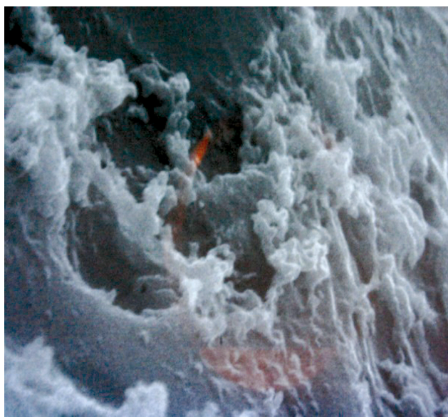
Рис. 3. Увеличение рельефа поверхности зубных протезов из акриловой пластмассы «Фторакс»; \times 400 , растровая электронная микроскопия.
