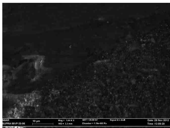
Рис. 4. Растровая электронная микроскопия эмалево-композитного соединения непосредственно после лечения (1-я группа, контрольная).
