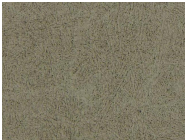
Рис. 1. Микроструктура образца из стали 20ХЗНЗМФБА после объемной термической обработки, x500
