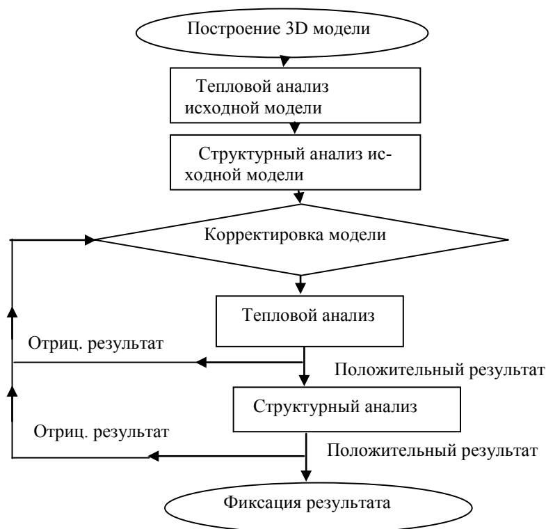
Рис. 2. Упрощенная схема тепловой оптимизации ротора ТК
