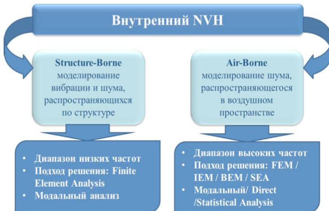
Рис. 1. Структура внутреннего NVH -анализа автомобиля
