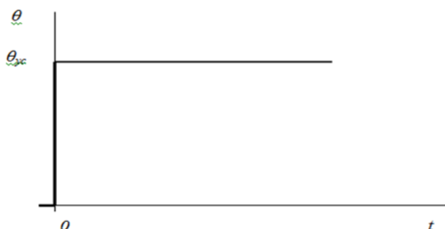
Рис. 2. Скачкообразная (ступенчатая) возмущающая функция
