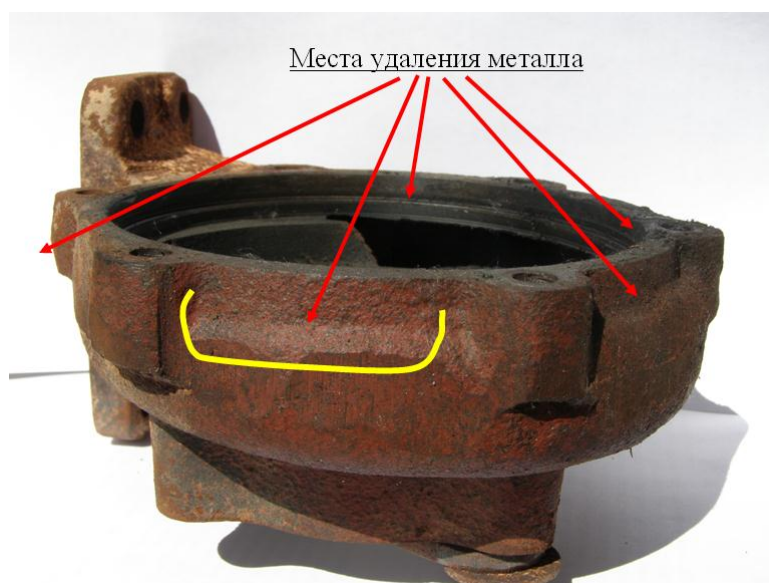
Рис. 3. Изменения в корпусе турбинной части ТКР 7 для обеспечения эффективности теплового экрана
