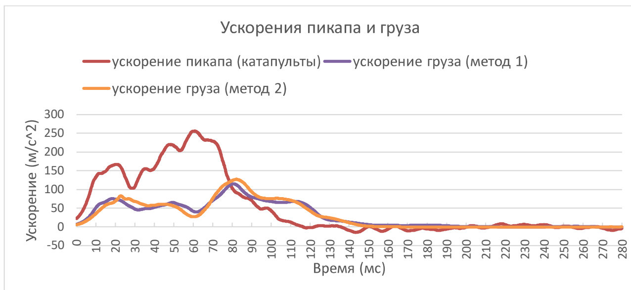
Рис. 9. Ускорение автомобиля и груза
