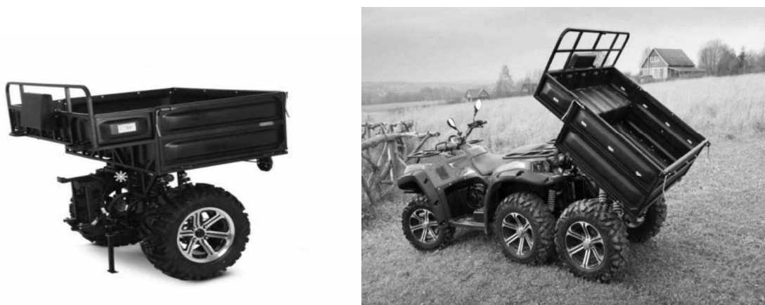
Рис. 1 Демонтируемый модуль грузовой платформы
