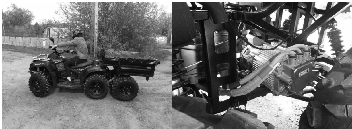
Рис. 2. Прототип гибридного мотовездехода с колесной формулой 6х6
