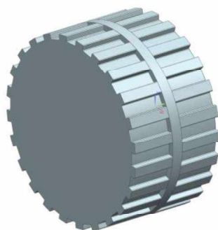
Рис. 8. 3D-твердотельная модель штампа-колеса
