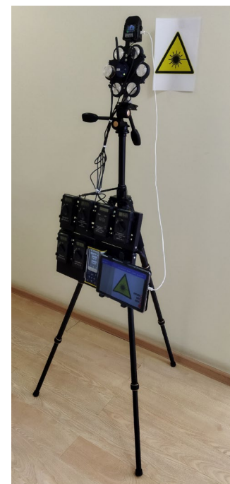
Рис. 4. Фотография специализированного стенда измерения энергетических характеристик отраженного излучения. Fig. 4. Photo of a special bench used to measure reflected radiation energy parameters.
